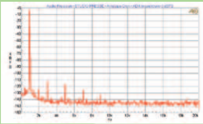
Diagramm 5: Klirrspektrum des A/D-Wandlers bei -3 dBFS
